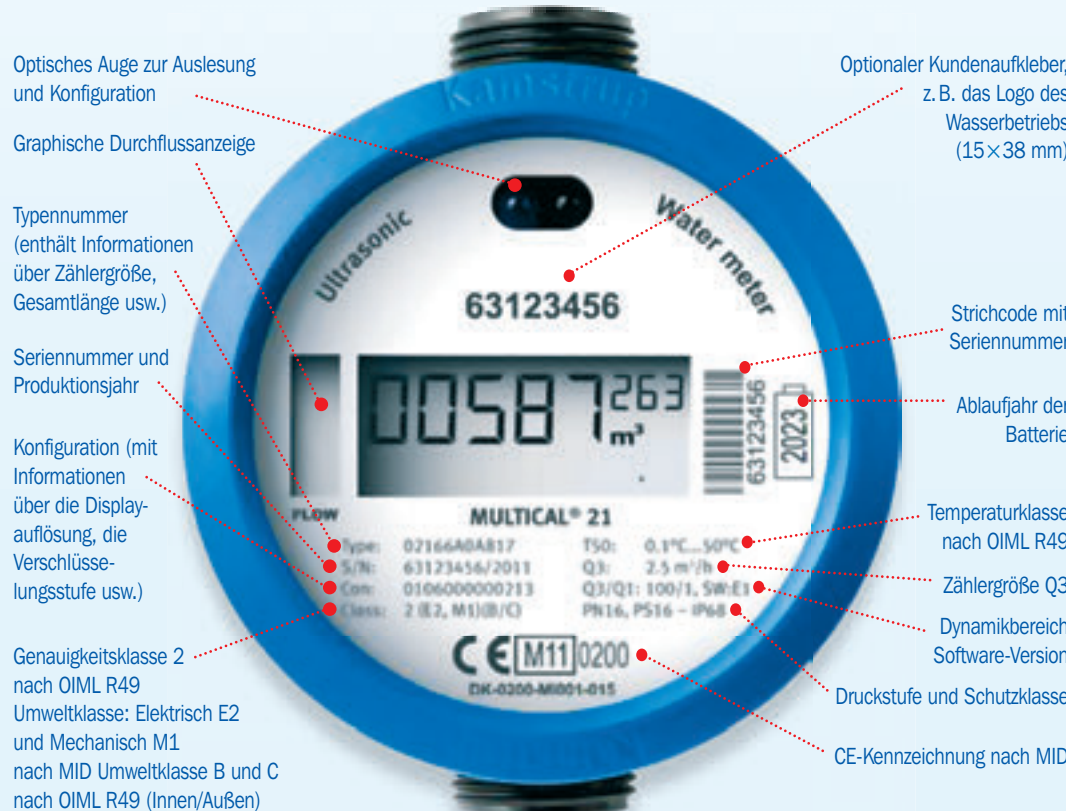
Beispiel für Ultraschallzähler, Fabrikat Kamstrup.
