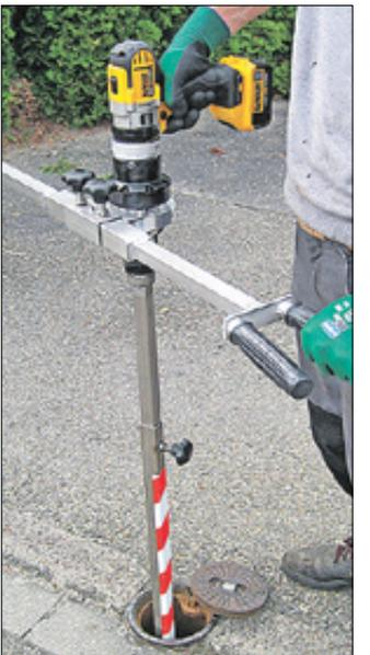
**Genial einfach – einfach genial: Die universellen, mobilen Akku-Schieberdrehmaschinen von elomat erleichtern das Schieberdrehen. Sie sind sehr leicht und kraftvoll, erlauben eine schnelle Inbetriebnahme, bieten diverse Abstützmöglichkeiten und lassen sich platzsparend in jedem Service-Fahrzeug transportieren.**
